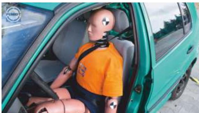
Během nárazu vozidla se sloupet nebyla bezpečnostní zóna řidiče v kabině narušena.
