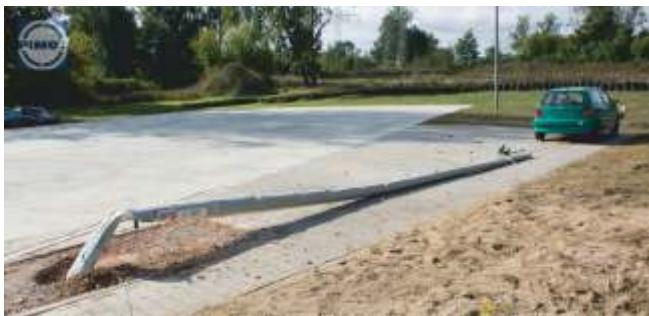
Během srážky vozidla se slouolem dochází k jeho bezpečnému položení se před vozidlem a sloup po celé délce absorbuje energii nárazu za zachování nejlepších parametrů pasivní bezpečnosti ASI a TH IV.
