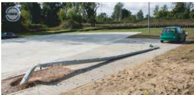
Bei einer Kollision des Fahrzeugs mit dem erfolgt sein sicheres Hinlegen vor dem Fahrzeug, und der Mast absorbiert auf seiner gesamten Länge die Energie des Aufpralls mit den besten passiven Sicherheitsparametern ASI und THIV.
