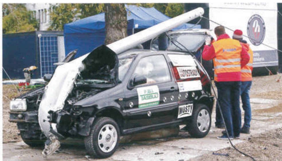
BEZPIECZNA KONSTRUKCJA SŁUPA ENERGETYCZNEGO TYPU NE POCHŁANIA ENERGIĘ ZDIERZENIA W NAJWYŻSZYM STOPNIU ZATRZYMUJE POJAZD NIE POWODUJĄC OBRAZÓW DLA KIEROWCY
