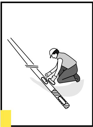
2 Przygotowanie słupa - odkręcanie drzwiczek inspekcyjnych słupa.
