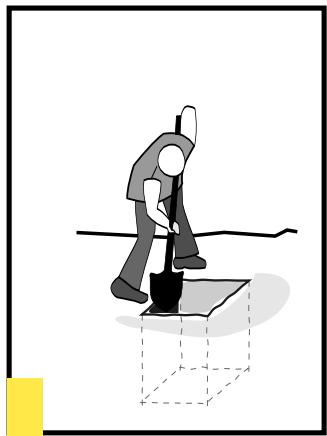
1 Wykonać wykop na posadowienie części wkopywanej słupa oświetleniowego zgodnie z wytycznymi.
