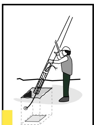
5 Włożenie słupa do przygotowanego wykopu.
