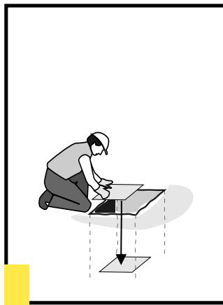
4 Ułożenie dodatkowej płyty zapobiegającej zapadaniu się słupa w gruncie.
